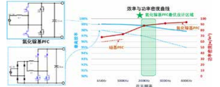
图7: 1.5KW 连续电流模式 PFC 的最高效率和功率密度
