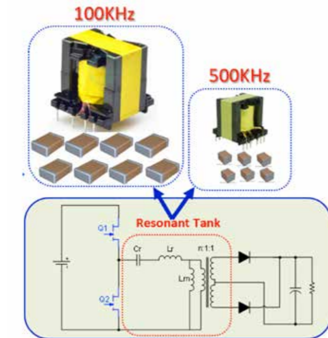
图 1: 工作在 100KHz 或 500KHz 频率下的半桥 LLC 谐振变换器
