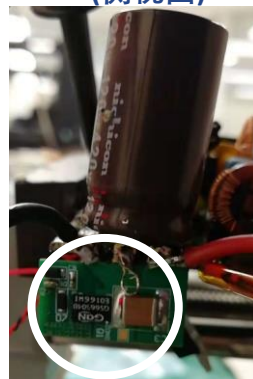
升压PFC电路 (控制芯片: L6562A) (侧视图)
