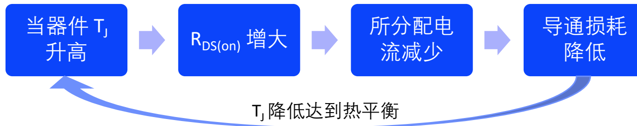
氮化镓的 R_{DS(on)} 与温度的关系
